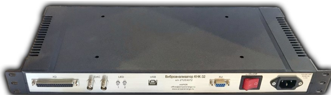
Р и с у н о к 4 – Внешний вид виброанализатора в промышленном исполнении (Вариант D)
